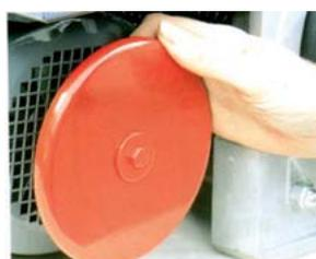
Un volant de dépannage, couplé à une manette de débloqué du frein, permet, sans courant, de descendre ou positionner une charge.
