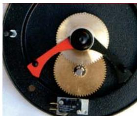
Type horloge: 2 position. Ce système facile à régler assure la sécurité en empêchant les dépassements haut et bas.
