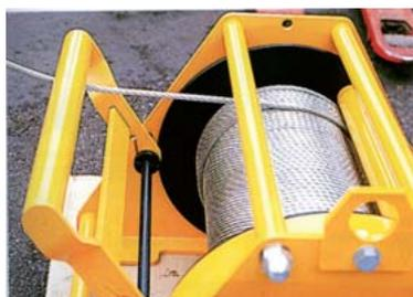
Ce dispositif arrête automatiquement le treuil lorsque le câble n'est plus tendu.
