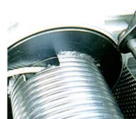
Il facilite l'enroulement correct du câble sur la première couche. Indispensable pour installer un système de va-et-vient.
