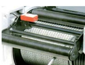
Ce dispositif arrête automatiquement le treuil lorsque le câble n'est plus tendu, par exemple en descente quand la charge rencontre un obstacle.
