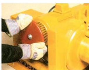
Ce dispositif comporte une manivelle ou un volant de commande associé à un déblocage du frein.
