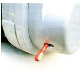
Le débloqué du frein permet la descente de la charge. Pour dérouler manuellement le câble, le tambour débrayable est nécessaire.
