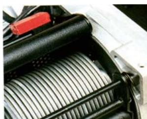
C'est le complément indispensable du tambour rainuré, dans le cas où le câble n'est pas tendu en permanence (enroulement à vide en traction). Cet équipement est déconseillé en cas d'enroulement du câble sur plusieurs couches.
