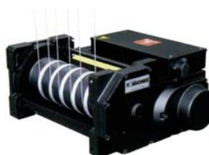
Pour tirer ou lever une charge avec différents points de fixation. Très utilisé dans les équipements scéniques.
