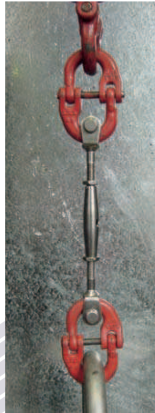
Essai de rupture d'un ridoir.
