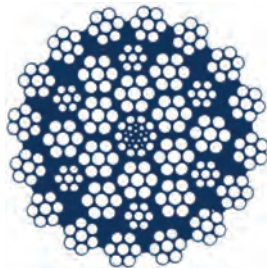
Câblage croisé ou lang
