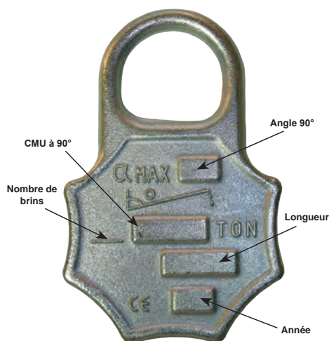
Plaquette N°2 TAG acier forgé ZINGUE
