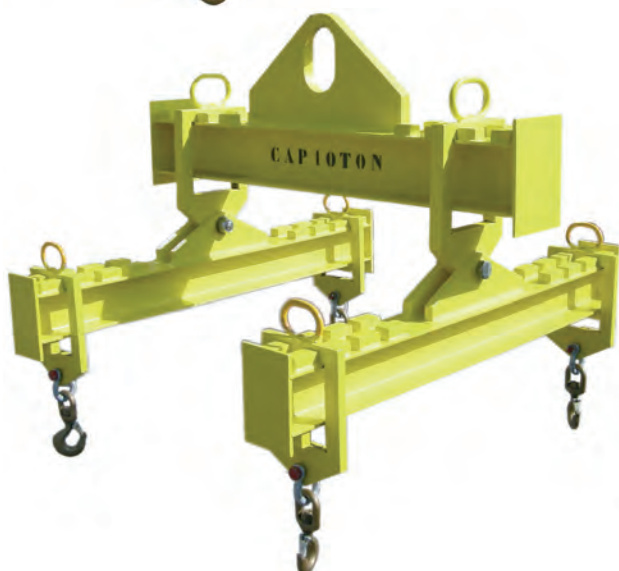
PALONNIER REGLABLE 10 TONNES 2 cadres supérieurs réglables de 1200 à 800 mm 4 cadres inférieurs réglables de 1200 à 800 mm Suspension rigide
