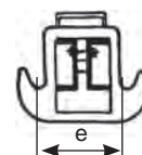
Crochet articulé sur une manille ou crochet pivotant sur demande (avec linguet de sécurité).
