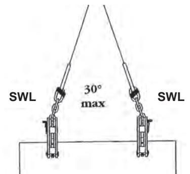
Fonction de levage de charges en position verticale à l'aide de 2 pinces sans palonnier
