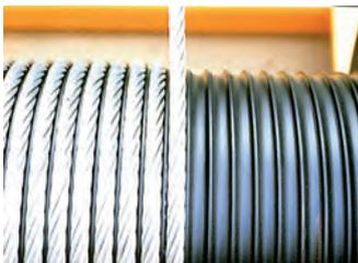
Il facilite l'enroulement correct du câble sur la première couche. Indispensable pour installer un système de va-et-vient.
