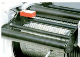
Ce dispositif arrête automatiquement le treuil lorsque le câble n'est plus tendu, par exemple en descente quand la charge reconte un obstacle.
