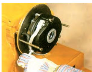
Il permet d'effectuer manuellement une manoeuvre de secours ou le positionnement précis de la charge (à partir du 2000 TE 6).
