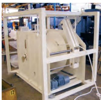
Treuil électrique de gestion de cordon (alimentation et communication) pour un robot sous-marin.
