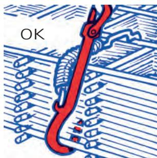
Les systèmes de sécurité anti-décrochage doivent obligatoirement être fixés à l'extérieur de l'élingage.
