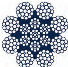
Câble avec âme métallique
